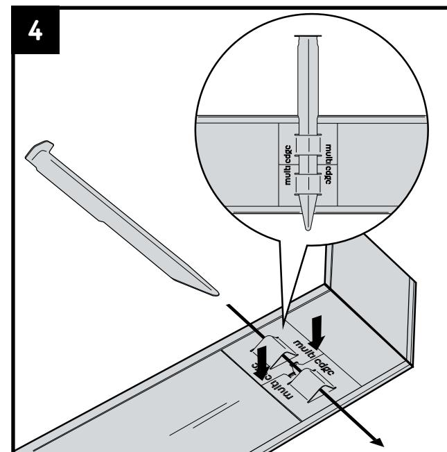
Appuyez les plaques d'accouplement contre le profil. Insérez le piquet dans les ouvertures des plaques d'accouplement et laissez la moitié du piquet dépasser au-dessus du profil.
