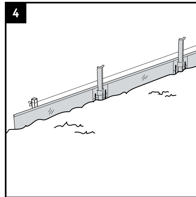
Plaats het profiel losjes in de uitgegraven sleuf. Buig het profiel met de hand voor een cirkel of gebogen vorm. Vouw het profiel om een stevig voorwerp (bijvoorbeeld de rand van een tafel) om een hoek te maken. Of gebruik de optionele hoekstukken (stap 6). Overtollige lengte afkorten met een slijptol of ijzerzaag.
