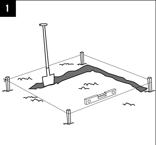
Markieren Sie mit Hilfe eines Seils und Pflöcken die Linie, auf welcher die Multi-Edge ADVANCE Kübel platziert wird. Entlang dieser Linie eine Rille ausgraben mit einer minimalen Tiefe von 10cm.
