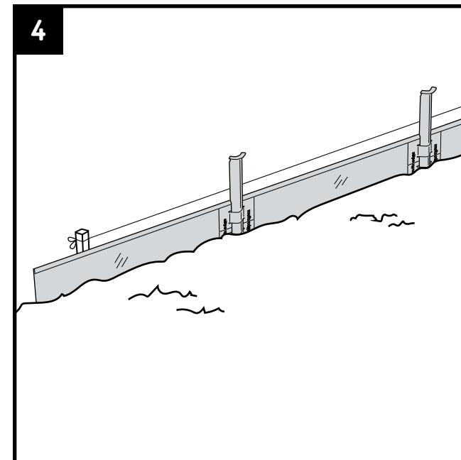
Posez le profil sans l'enfoncer dans la tranchée précédemment creusée. Pour faire un cercle ou obtenir une forme incurvée, pliez le profil à la main. Pour faire un angle, pliez le profil sur une surface dure (par exemple, le rebord d'une table). Ou utilisez les pièces d'angle disponibles en option (étape 6). Coupez la longueur en trop avec une meuleuse ou une scie à métaux.
