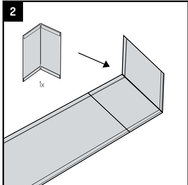
Die Profile werden miteinander verbunden, indem die Eckstücke mit Kuppelplättchen und Bodenstecker verankert werden. Beginnen Sie daher damit, alle Eckstücke an den Profilen zu befestigen. Setzen Sie das Eckstück an das Profil an.
