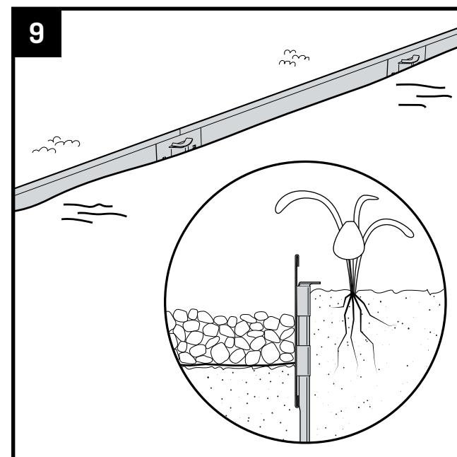
Rellene la zanja con tierra, arena u otro material. Luego coloque césped, grava u otro material de cubrimiento contra la bordura.
