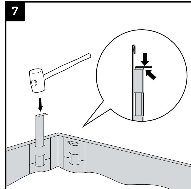
Mit einem Hammer schlagen Sie vorsichtig alle Bodenstecker in den Boden bis die Oberseite das Kuppelplättchen berührt. Schliessen Sie die Nähte bei den Enden der Profilstücke und Eckstücke, indem Sie die Enden gegeneinanderdrücken und schlagen Sie danach den Bodenstecker vorsichtig in den Boden.
