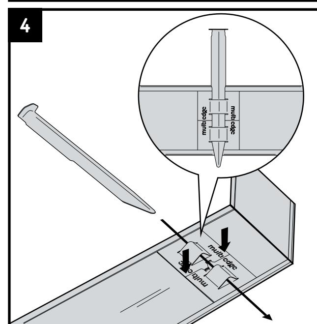
Presione las placas de unión contra el perfil. Inserte la estaca a través las aberturas de las placas de unión, dejando que la mitad de la estaca sobresalga por encima del perfil.
