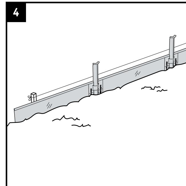
Inserte la bordura de forma suelta en la zanja excavada. Doble el perfil a mano para formar círculos o formas curvas. Doble el perfil sobre un objeto sólido (por ejemplo, el borde de una mesa) para hacer un ángulos rectos. También puede usar las piezas de esquina opcionales (paso 6). Acorte el exceso de longitud con una sierra para metales.
