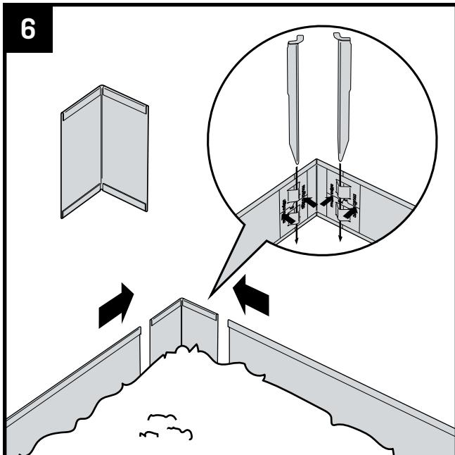
Pour obtenir des angles à 90° parfaits, utilisez les pièces d'angle disponibles en option. Raccordez les pièces d'angle aux profils à l'aide des plaques de couplage. Appuyez les plaques de couplage contre le profil et enfoncez le piquet de fixation dans les ouvertures des plaques, en laissant la moitié du piquet dépasser au-dessus du profil de bordure.
