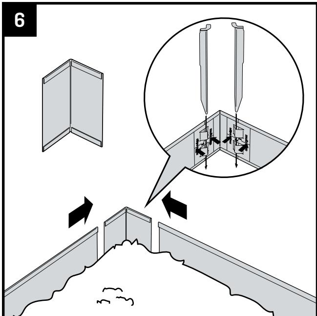
Para ángulos de 90° perfectos, use las piezas de esquina. Conecte la pieza de esquina a los perfiles con las placas de unión. Presione las placas de unión contra el perfil y pase la estaca a través de las aberturas de las placas de unión. Deje que la mitad de la estaca sobresalga por encima del perfil.
