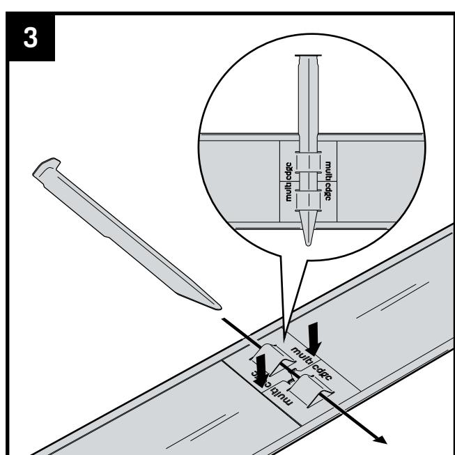
Drücken Sie die Kuppelplättchen gegen das Profilstück. Stecken Sie den Bodenstecker durch die Öffnungen in den Kuppelplättchen und lassen Sie die Hälfte des Bodensteckers über das Profilstück hinausstehen.
