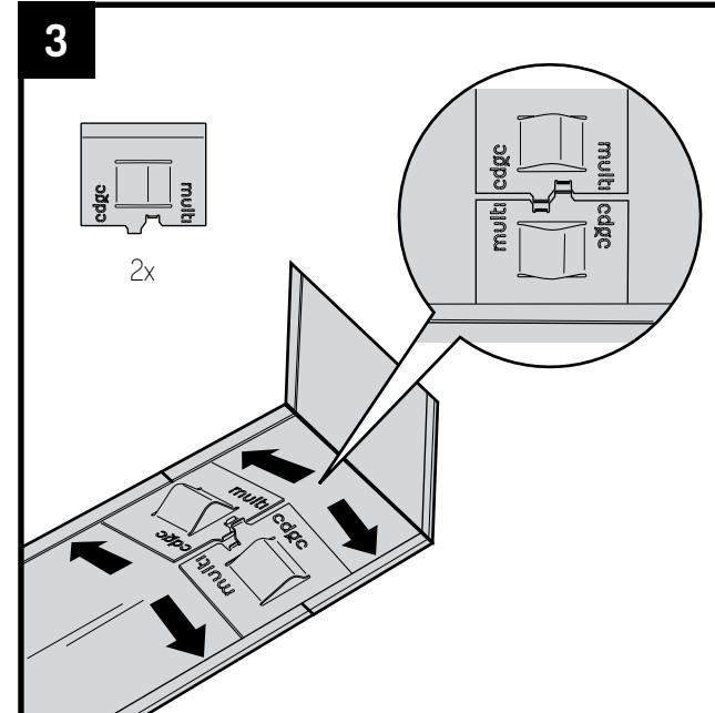
Placez une plaque d'accouplement dans les bords supérieur et inférieur du profilé. Faites-le au niveau de la jointure entre le profil et la pièce d'angle. Veillez à ce que les plaques d'accouplement s'emboîtent les unes dans les autres.
