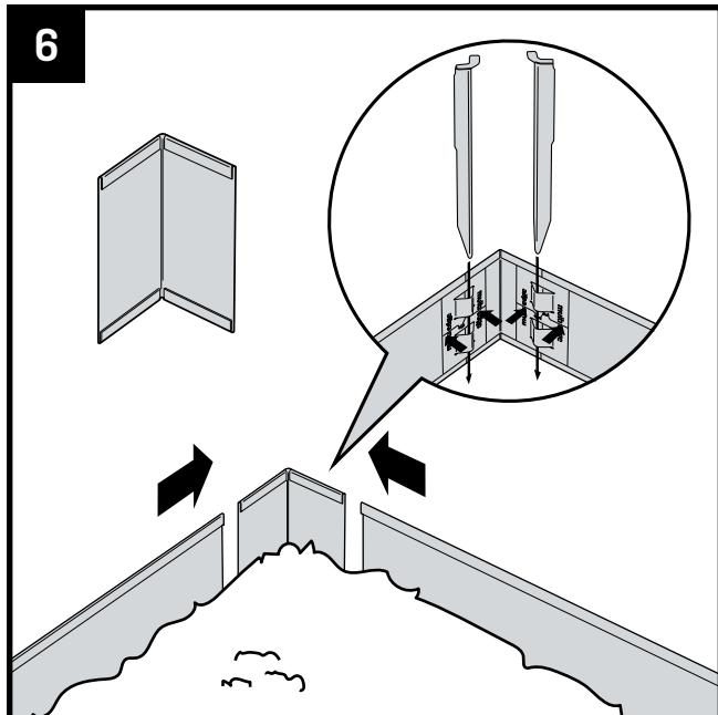
Verwenden Sie die optionalen Eckstücke für extra gerade 90° Winkel. Kuppeln Sie mit Hilfe der Kuppelplättchen die Eckstücke an die Profilstücke. Drücken Sie die Kuppelplättchen gegen das Profilstück und schlagen Sie den Bodenstecker durch die durch die Öffnungen in den Kuppelplättchen hindurch und lassen Sie die Hälfte des Bodensteckers über dem Profilstück herausstehen.
