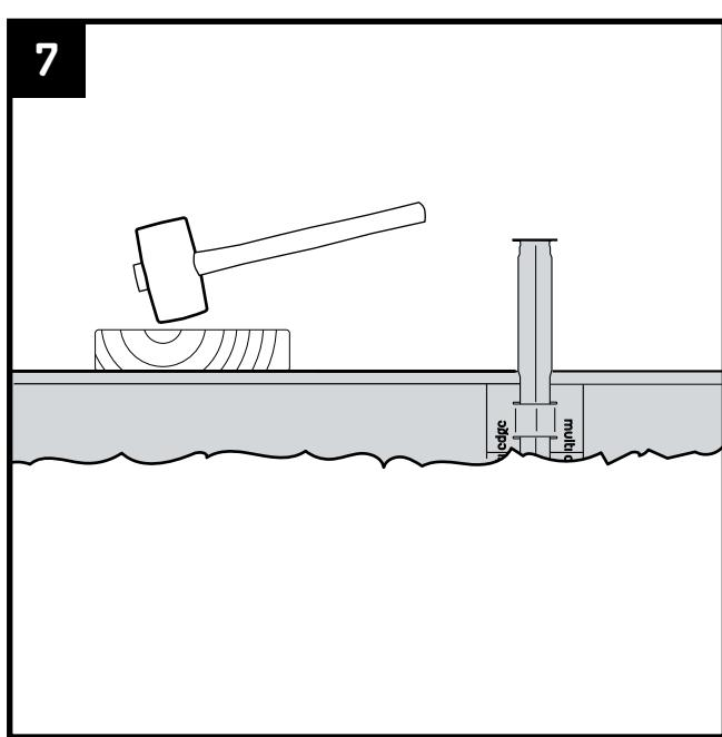
Klopfen Sie die Profilstücke auf die gewünschte Höhe. Verwenden Sie einen Holzblock um zu verhindern, dass die Profilstücke beschädigt werden. Lassen Sie nicht mehr als 10cm des Profilstücks über dem Boden herausstehen um eine optimale Stabilität zu gewährleisten.
