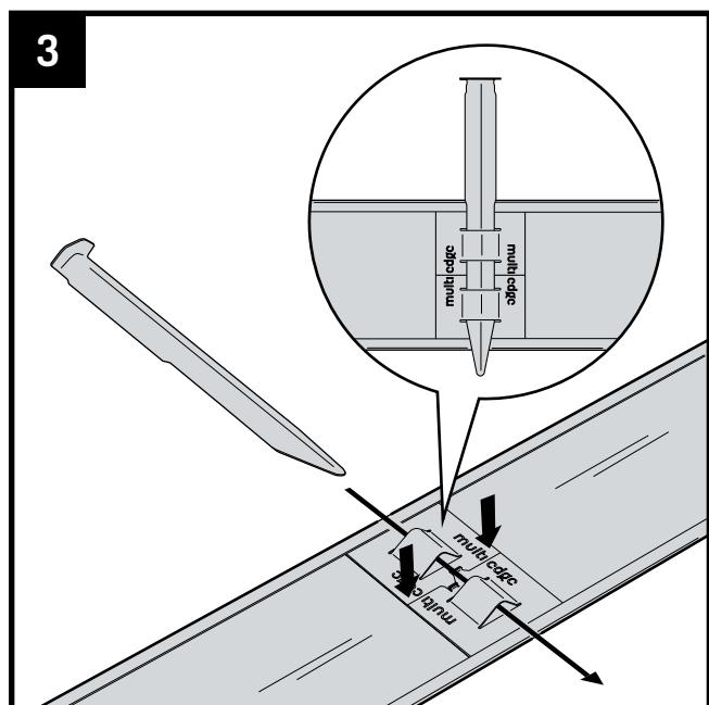
Druk de koppelplaatjes tegen het profiel. Steek de grondpin door de openingen in de koppelplaatjes en laat de helft van de grondpin boven het profiel uitsteken.
