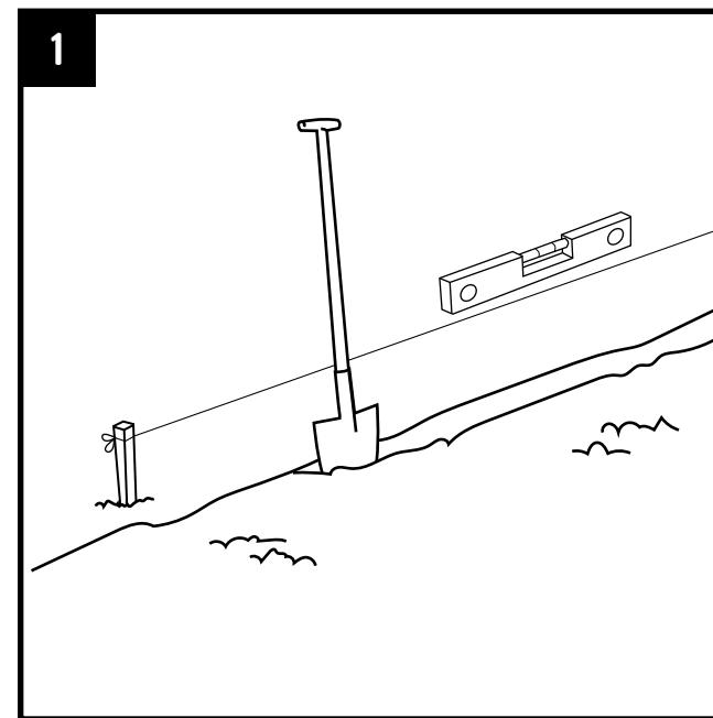
Markieren Sie mit Hilfe eines Seils und Pföcken die Linie, auf welcher die Multi-Edge ADVANCE Abschlusskante platziert wird. Entlang dieser Linie eine Rille ausgraben mit einer minimalen Tiefe von 10cm.
