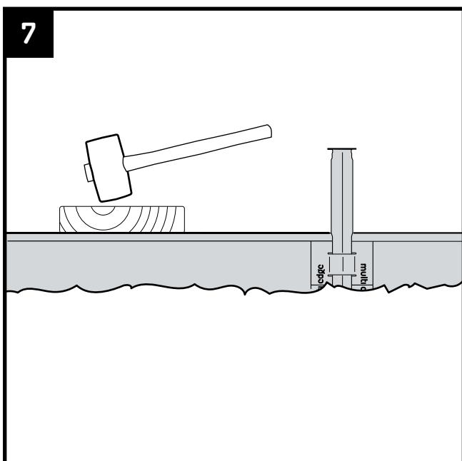
Tapez doucement sur les profils pour les enfoncer à la hauteur souhaitée. Utilisez un bloc de bois pour éviter d'endommager les profils. Pour plus de stabilité, ne faites pas dépasser le profil du sol de plus de 10 cm.
