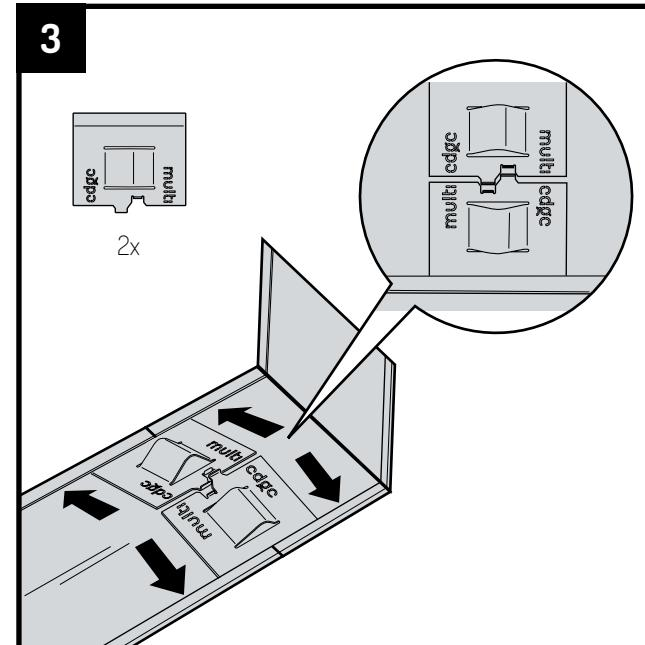
Inserte una placa de unión en los bordes superior e inferior del perfil. Hágalo a la altura de la transición entre el perfil y la pieza de esquina. Asegúrese de que las placas de unión encajen entre sí.
