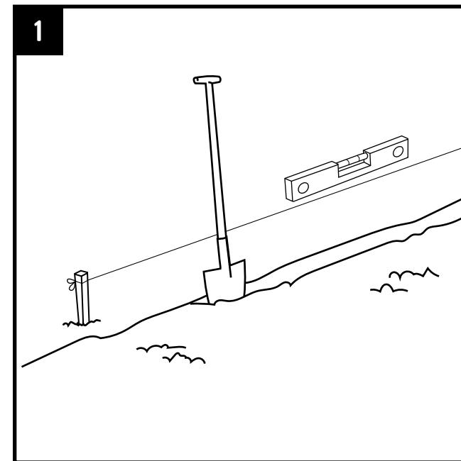
À l'aide d'une corde et de piquets, marquez la ligne sur laquelle le Multi-Edge ADVANCE sera placé. Creusez une tranchée d'au moins 10 cm de profondeur le long de cette ligne.
