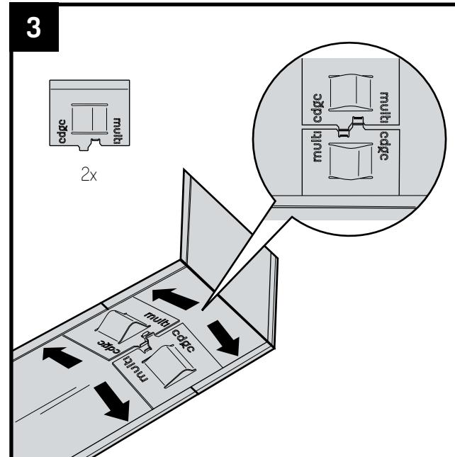
Plaats in de boven- en onderrand van het profiel een koppelplaatje. Doe dit op de naad van de overgang tussen het profiel en het hoekstuk. Zorg dat de koppelplaatjes in elkaar vallen.
