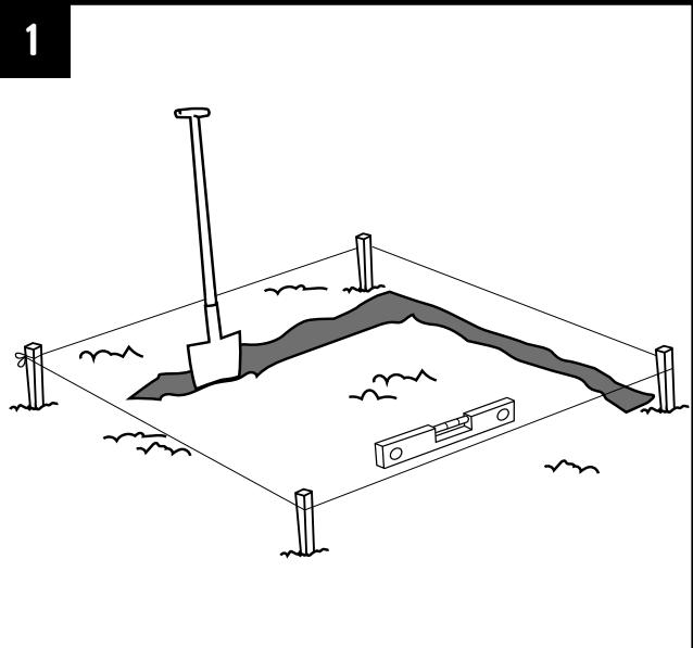
Gebruik piketpaaltjes en touw om de vorm van de plantenbak uit te zetten. Graaf vervolgens langs deze lijn een sleuf van minimaal 10 cm diep.
