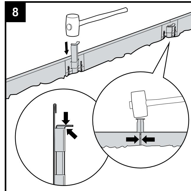
Enfoncez tous les piquets de fixation dans le sol en tapant doucement avec un marteau jusqu'à ce que le haut du piquet touche la plaque de couplage. Fermez les jointures aux extrémités des profils et des pièces d'angle en appuyant les extrémités l'une sur l'autre, puis enfoncez doucement le piquet de fixation dans le sol.
