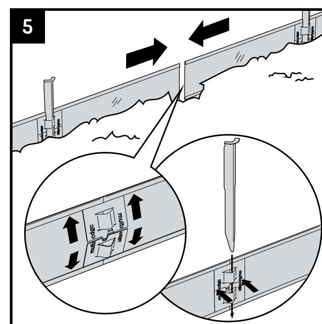
Para unir los perfiles entre sí. Si es necesario, excavue un poco más la zanja a la altura que se vayan a unir los perfiles. Colóquelos de manera contigua y presione las placas de unión en la parte superior e inferior de los perfiles. Pase la estaca a través de las aberturas de las placas de unión. Deje que la mitad de la estaca sobresalga por encima del perfil.
