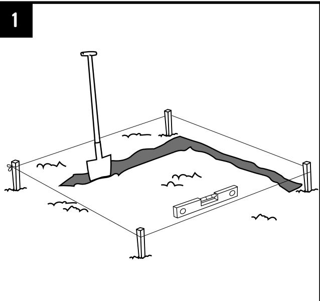
Utilisez des piquets et de la corde pour délimiter la forme de la jardinière. Creusez ensuite une tranchée le long de cette ligne, d'une profondeur minimale de 10 cm.
