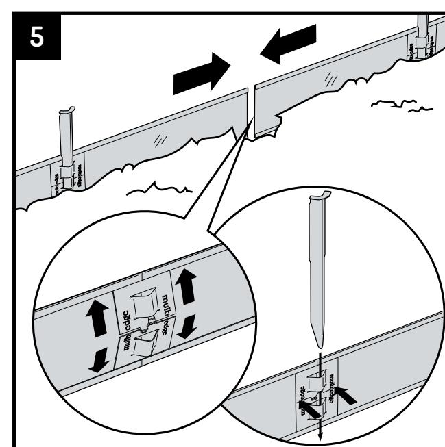
Vergrössern Sie eventuell die ausgegrabene Rille etwas bei den Enden der Profilstücke. Platzieren Sie die Kuppelplättchen in den Ober- und Unterrand des Profilstücks. Drücken Sie die Kuppelplättchen gegen das Profilstück und schlagen Sie den Bodenstecker durch die Öffnungen in den Kuppelplättchen hindurch. Lassen Sie die Hälfte des Bodensteckers über dem Profilstück herausstehen.
