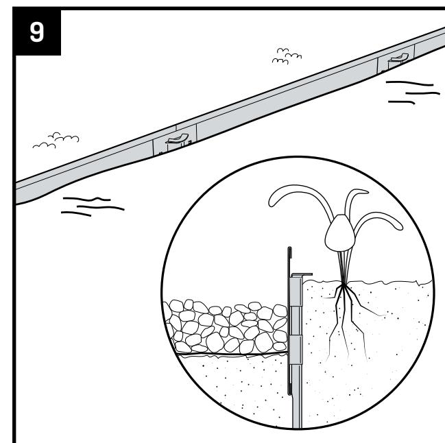
Vul de sleuf op met grond, zand of ander materiaal. Leg daarna gras, grind of een andere bodembedekker tegen de afboording aan.
