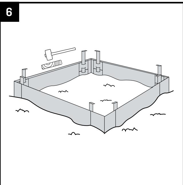
Setzen Sie den Pflanzkübel in den Graben. Klopfen Sie vorsichtig die Profile auf die gewünschte Höhe. Verwenden Sie ein Holzstück, um zu verhindern, dass die Profile beschädigt werden. Lassen Sie nicht mehr als 10 cm des Profils aus dem Boden herausragen, um die Stabilität zu gewährleisten.
