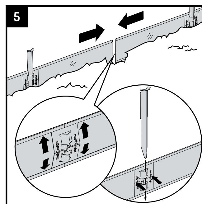
Si nécessaire, agrandissez légèrement la tranchée creusée aux extrémités des profils. Placez les plaques de couplage dans le rebord supérieur et inférieur du profil. Appuyez les plaques de couplage contre le profil et enfoncez le pique de fixation dans les ouvertures des plaques. La moitié du pique doit dépasser du profil.
