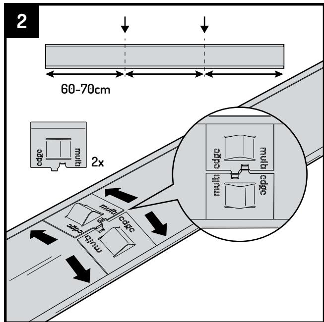
Plaats voordat de profielen in de grond gezet worden eerst om de 60 - 70cm 2 koppelplaatjes om de grondpinnen te bevestigen aan het profiel.
