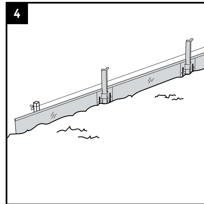
Stecken Sie das Profilstück lose in die im Boden ausgegrabene Rille. Biegen Sie das Profilstück mit der Hand in kreisförmige oder gewellte Formen. Mit Hilfe eines Holzblockes oder einer Werkbank können Sie das Profilstück vorsichtig in einen erwünschten Winkel biegen. Oder verwenden Sie dazu die optionalen Eckstücke (Schritt 6). Überstehende Längen können mit einer Schleifscheibe oder Eisensäge gekürzt werden.
