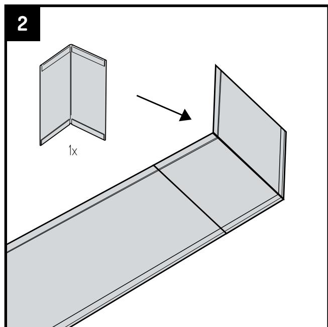
Les profils sont fixés les uns aux autres en ancrant les pièces d'angle à l'aide de plaques d'accouplement et des piquets de fixation. Commencez donc par fixer toutes les pièces d'angle aux profils. Placez la pièce d'angle contre le profil.
