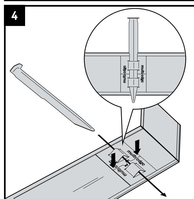
Druk de koppelplaatjes tegen het profiel. Steek de grondpin door de openingen in de koppelplaatjes en laat de helft van de grondpin boven het profiel uitsteken.
