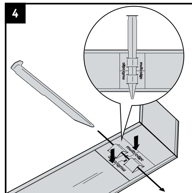
Drücken Sie die Kuppelplättchen gegen das Profil. Stecken Sie den Bodenstecker durch die Öffnungen in den Kuppelplättchen und lassen Sie die Hälfte des Bodenstecker über das Profil hinausragen.
