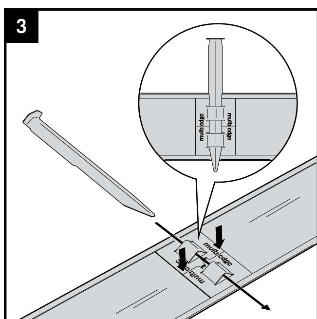
Appuyez les plaques de couplage contre le profil. Insérez le pique de fixation à travers les ouvertures des plaques de couplage et laissez la moitié du pique dépasser au-dessus du profil.
