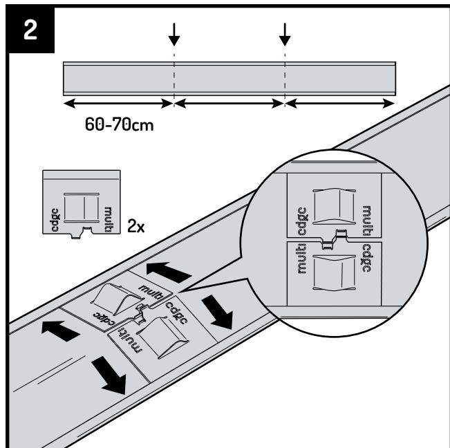
Avant de placer les profils dans le sol, mettez 2 plaques de couplage tous les 60 à 70 cm pour fixer les piquets sur le profil. Pour ce faire, placez une plaque de couplage dans le rebord supérieur et inférieur du profil. Assurez-vous que les plaques de couplage sont bien emboîtées.
