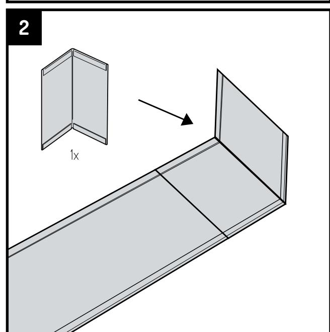
Los perfiles se fijan entre sí anclando las piezas de esquina con placas de unión y estacas. Por lo tanto, comience fijando todas las piezas de esquina a los perfiles. Coloque la pieza de esquina contra el perfil.
