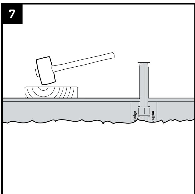
Presione cuidadosamente los perfiles en el terreno hasta la altura deseada. Use un bloque de madera para evitar dañar los perfiles. Para garantizar la estabilidad del producto no permita que la bordura sobresalga 10cm o más del terreno.
