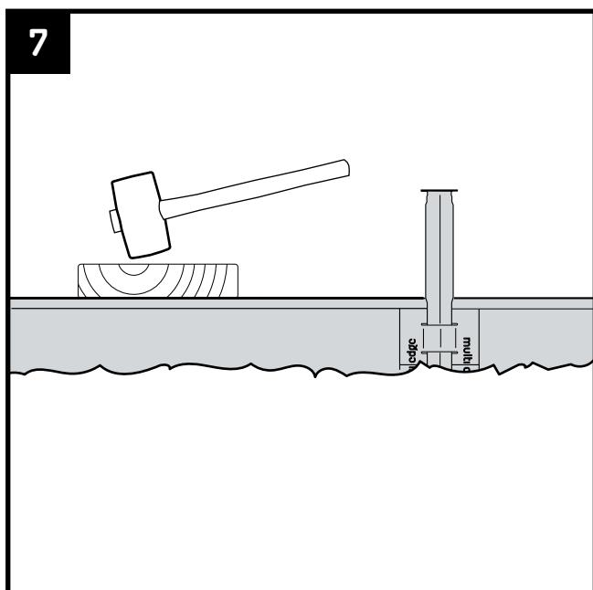
Tik voorzichtig de profielen op de gewenste hoogte. Gebruik een houtblok om te voorkomen dat de profielen beschadigen. Laat niet meer dan 10cm van het profiel boven de grond uitsteken voor de stabiliteit.
