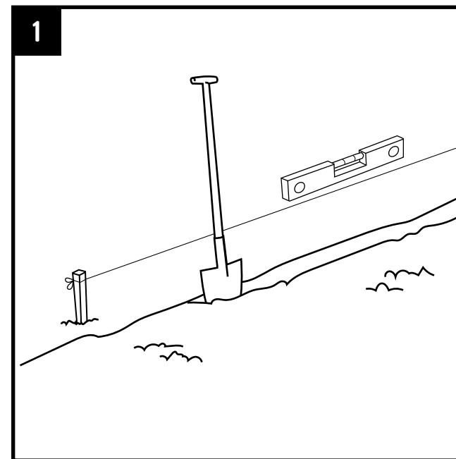
Markeer met behulp van touw en piketpaaltjes de lijn waarop de Multi-Edge ADVANCE geplaatst wordt. Graaf langs deze lijn een sleuf van minimaal 10cm diep.
